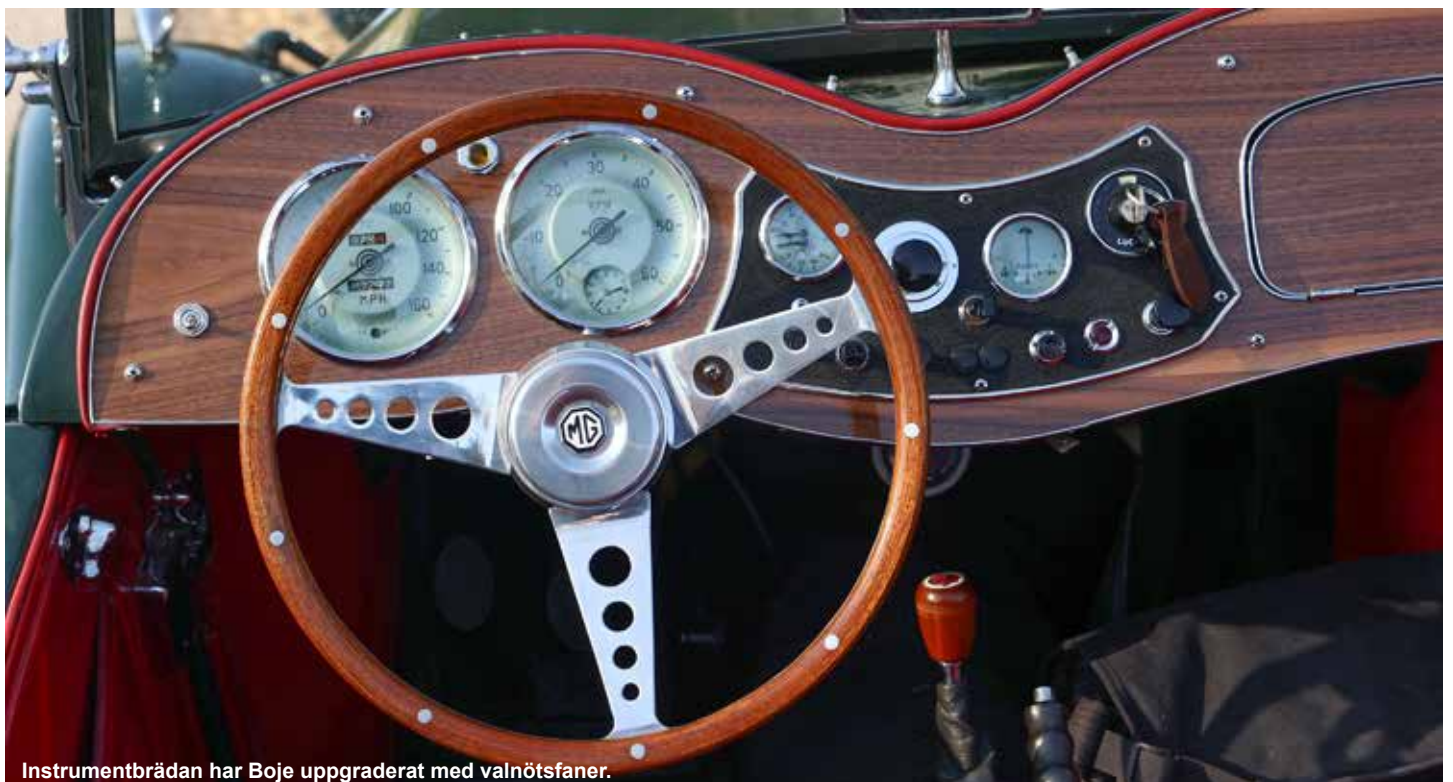
Varvräknaren drivs numer av en växel från fördelaren.
