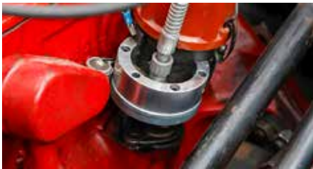
Varvräknaren drivs numer av en växel från fördelaren.
